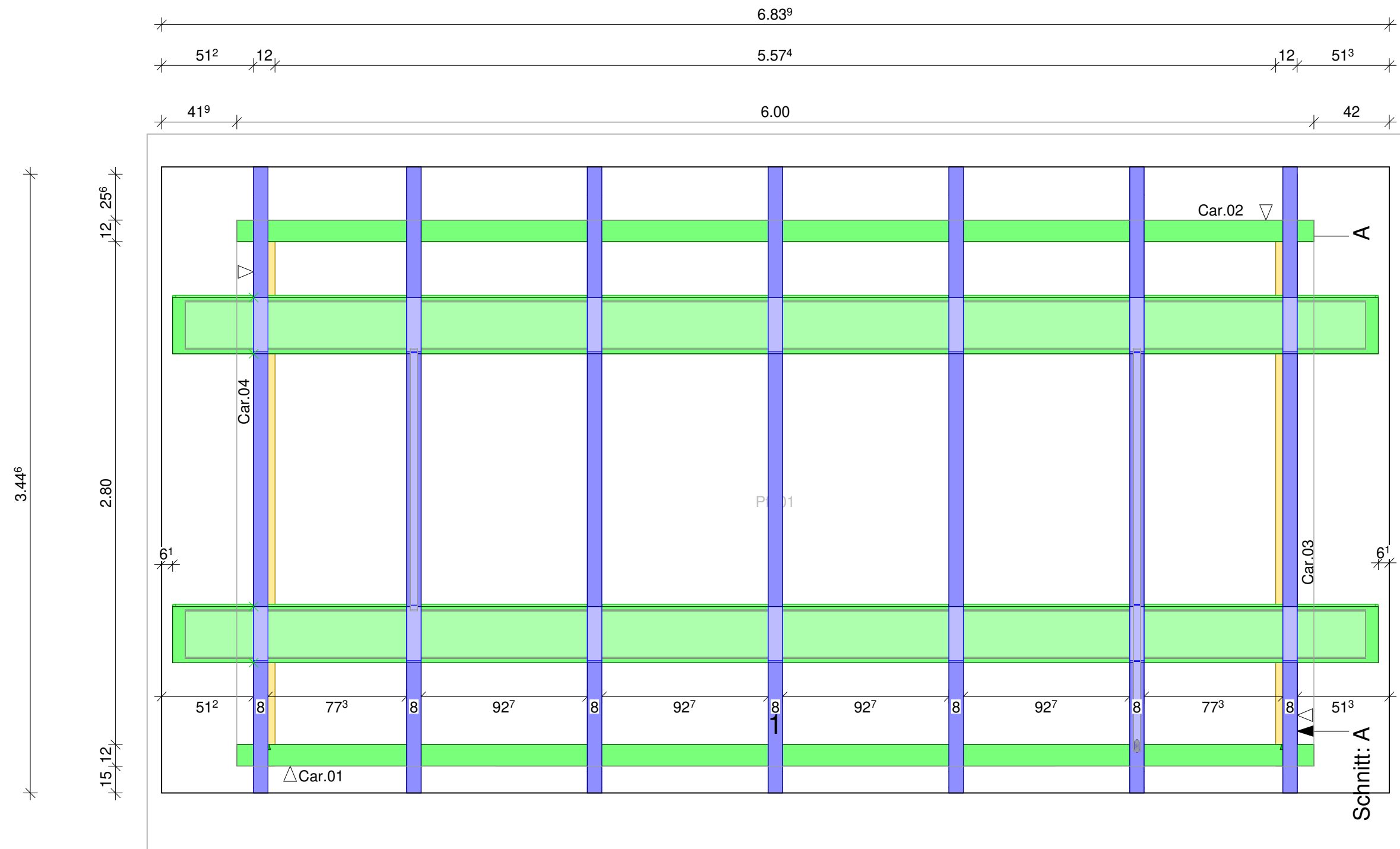
Solarcarport Typ II, 2 Stellplätze, 12 Module
